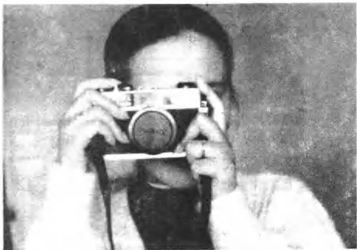
图3 135 平视式相机的镜头盖如忘记取下,在取景器内不易发觉。
