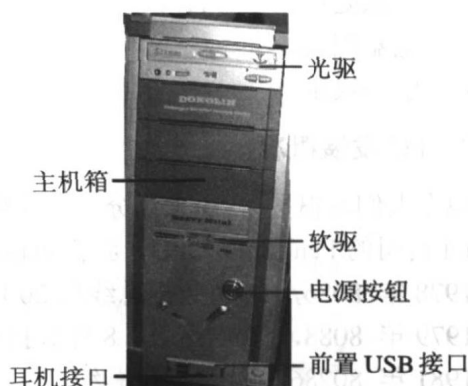
图 1.3 计算机主机的组成（外部）
