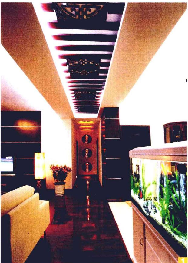
**1** 吊顶为石膏板及装饰面板材质。施工做法为：先用木龙骨做出框架及结构，之后用石膏板封面，自攻螺钉固定，然后按设计图纸封饰面板以及雕刻造型，最后饰面板表面刷哑光木器漆及石膏板刷乳胶漆。整体造价大约在300元/平方米。
