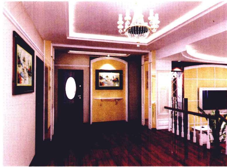
2 过道吊顶为石膏板及木造型材质。施工做法为：先用木龙骨做出框架及结构，之后用石膏板封面，自攻螺钉固定，然后挂装刷好漆的木造型，最后石膏板表面刷乳胶漆。整体造价大约在320元/平方米。
