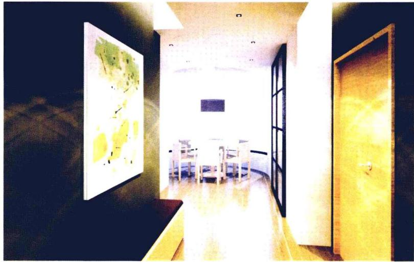
1 过道墙面为乳胶漆材质，施工做法为：先将墙面上的起皮杂物等清理干净，之后用配好的石膏腻子将墙面等破损处找平补好，腻子干燥后用砂纸将凸出处打磨平整。然后用橡胶刮板横向满刮腻子，接头处不得留槎，每一刮板最后收头时要干净利落。最后涂刷1~3遍乳胶漆。整体造价大约在60元/平方米。
