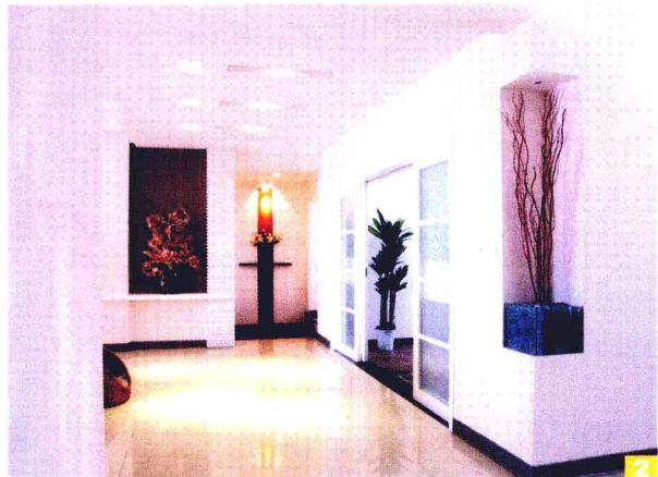
**2** 过道地面为玻化砖材质。施工做法为：先将选好的陶瓷地砖清洗干净后，放入清水中浸泡2~3小时后，取出晾干备用。之后排砖，当排砖确定后，应用方尺规方，每隔3~5块砖在结合层上弹纵横或对角控制线。然后开始铺砖，铺完一个区域后，压实并拔缝调直，最后勾缝剂勾缝。整体造价大约在230元/平方米。
