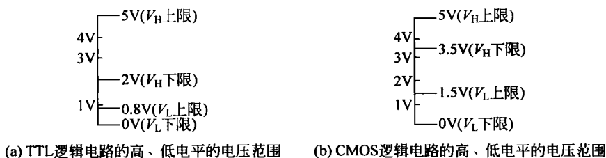
图 1-1 高、低电平的电压范围
