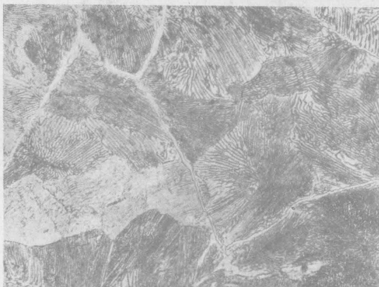
圖10 過共析鋼珠光體用不同侵蝕劑侵蝕結果。 \times 500
