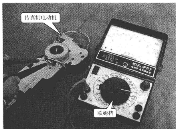
图 1-9 使用指针式万用表检测传真机电机引脚间阻值
