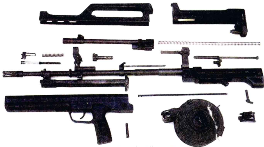
95式轻机枪结构分解图
