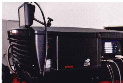
中视中科光电技术公司研发的 首台应用激光 3D 数字电影放映机
