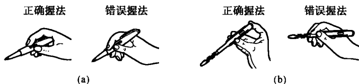
图 1-4 低压验电器握法
