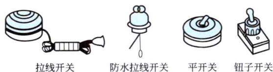
图 1-21 照明开关外形
