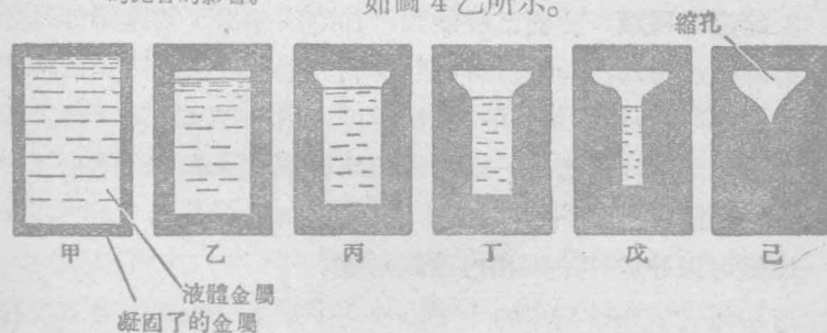
圖3 鑄件逐漸凝固和產生縮孔的示意圖。
