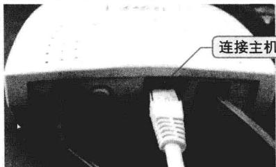
取一根网线，将一端插入ADSL Modem中间的网络接口，另一端与主机的网卡接口相连。
