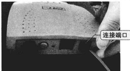
将室内电话线接入ADSL Modem右侧相应的接口中。
