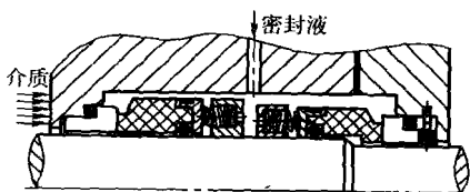
图1-7 背靠背双端面机械密封(旋转式)
