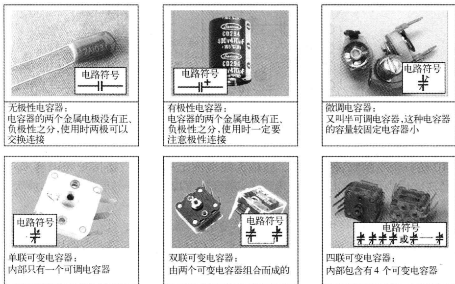
图1-7 典型电容器在电路图中的标识
