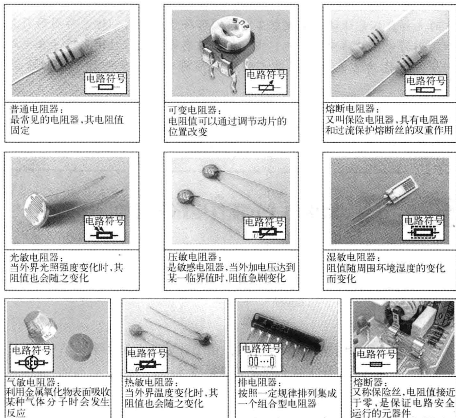
图 1-3 电工电路中常见电阻器的种类特点
