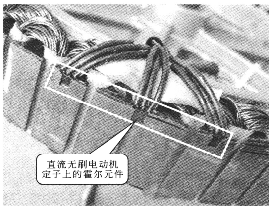
图 1-5 直流无刷电动机上的霍尔元件
