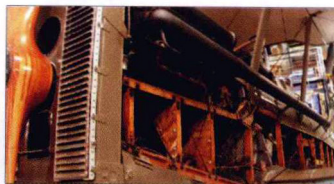
机身前半段为木质半硬壳构造，后半段为木质骨架加亚麻蒙布的传统构造。
