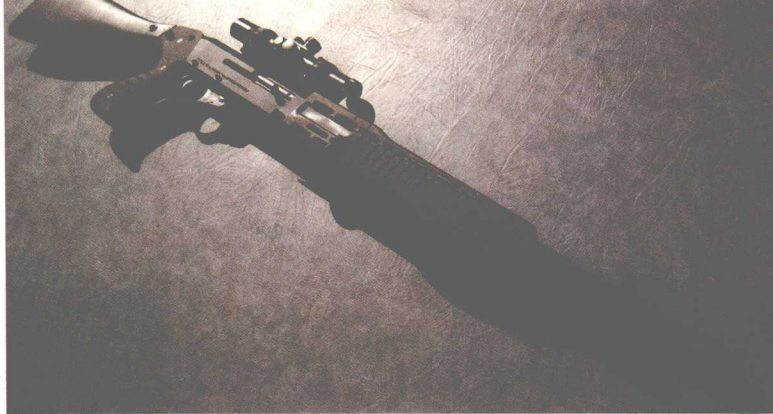
SPAS-12多功能霰弹枪，与一般霰弹枪（下图）相比，它的枪管上有一个独特的隔热罩
