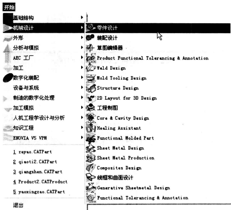
图 1-1-1 【开始】→【机械设计】→【零件设计】
