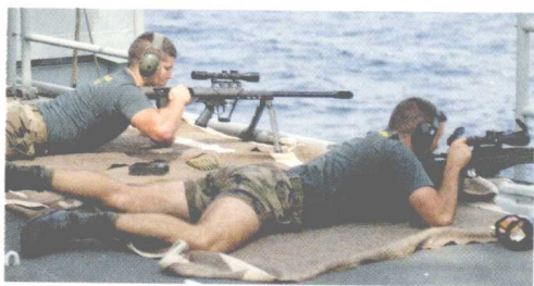
↑ M82狙击步枪的两脚架与M60机枪通用，握把则与M16A2步枪通用。
