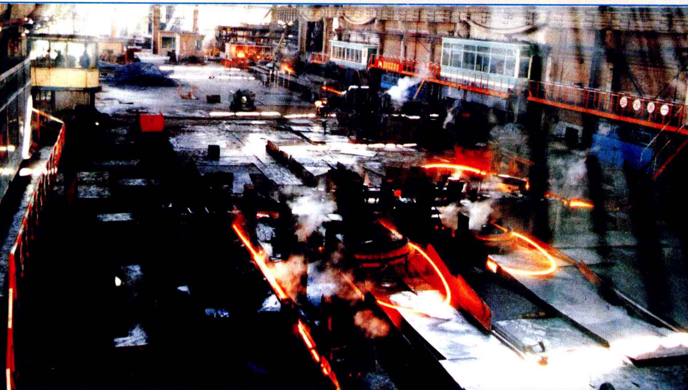
济南钢铁总厂轧钢分厂由捷克 引进的250半连轧机生产线
