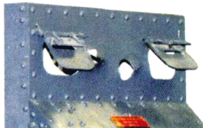
有机枪射口但却没有设置枪座
