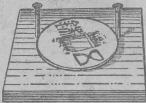
圖1. 銅錢熱脹冷縮的實驗
