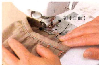
15 从袖子的正面开始缝合袖口端。从袖下线开始 (不回针缝)，缝制，结束使用回针缝。
