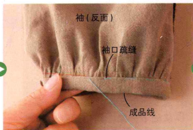
14 以成品线为袖口外缘，折合袖口。反面折叠 0.8cm 缝份，距车缝迹 0.2cm 处重合对接，袖口边缘用疏缝线缝合。确认正面的袖子侧位置有无缝合。
