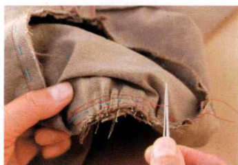
13 用锥子挑出袖山的粗缝针脚和疏缝线。
