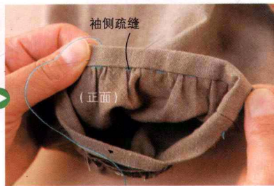
14 以成品线为袖口外缘，折合袖口。反面折叠 0.8cm 缝份，距车缝迹 0.2cm 处重合对接，袖口边缘用疏缝线缝合。确认正面的袖子侧位置有无缝合。
