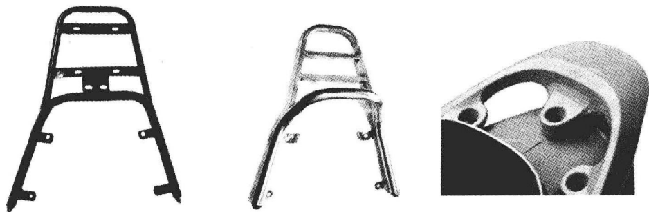
图 1-5 电动车后衣架外形实物
