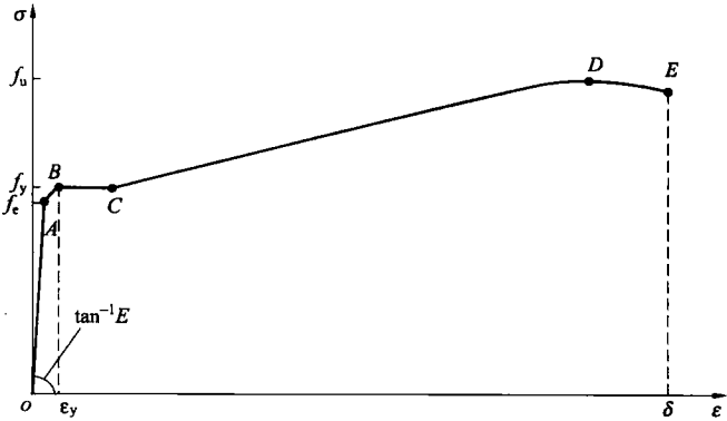
图 1.9 低碳钢在常温静载下的单向拉伸 \sigma-\varepsilon 曲线
