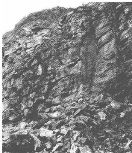
图 1.2 由岩体内部节理面滑移引发的结构性破坏 [56]
