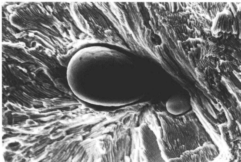
SWRH82B 钢连铸坯断口上的橄榄球状 (Mn, Fe)S 夹杂物
