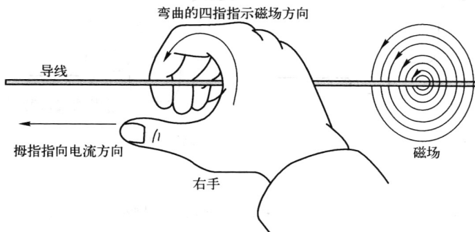
图 1-3-6 电流流过导体会产生磁场
