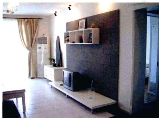
**1** 主题墙为密度板材材质，面喷白漆。施工做法为：选用中密度板材，用胶粘剂逐层粘贴至设计厚度，然后手工或机械雕刻成设计图案，最后表面喷白色木器漆。整体造价大约在3000元/项。
