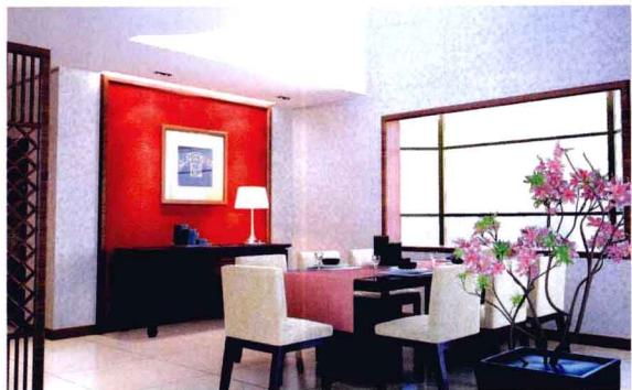
**1** 主题墙为装饰壁纸材质。施工做法为：用壁纸胶把装饰壁纸粘贴在墙面上。整体造价大约在195元/平方米。
