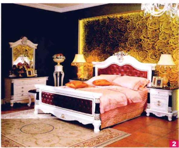
**1** 主题墙为装饰壁纸材质。施工做法为：用壁纸胶把装饰壁纸粘贴在墙面上，施工时注意壁纸要刮平，不留气泡或褶皱。外框用不锈钢装饰条收边。整体造价大约在250元/平方米。
