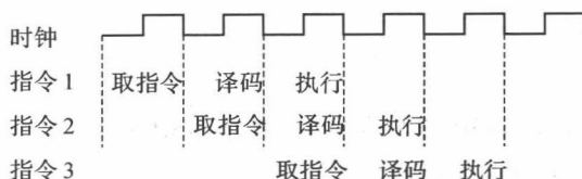
图 1-2 哈佛结构处理器指令流的定时关系
