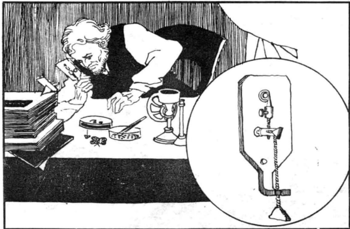
10. 他把两块镜片隔开一些距离，固定在一块金属板上。在它们中间，还安上一根用来调节镜片距离的螺旋杆。这架可以放大近三百倍的显微镜，可称得上是最精巧的了。
