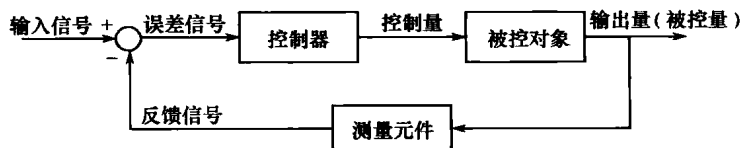
图 1.3 闭环控制系统的基本结构
