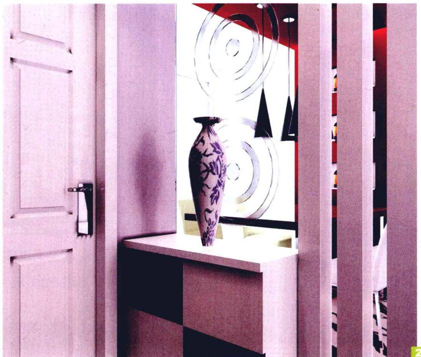
**1** 玄关背景墙为装饰壁纸材质。施工做法为：先按照设计图纸用木龙骨做出框架及结构（假墙），用大芯板作为底材，然后用壁纸胶把装饰壁纸粘贴在大芯板上，最后粘贴成品中式纹理装饰镜。整体造价大约在1000元/项。
