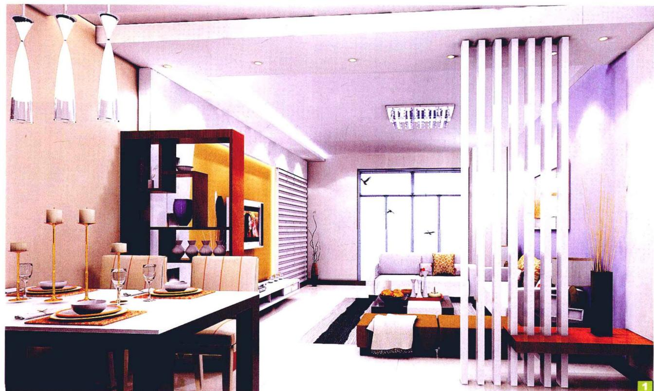
**1** 玄关隔断为木器漆及饰面板材质。施工做法为：先按照设计图纸用木龙骨做出框架及结构，然后用裁切好的大芯板封面，最后大芯板表面喷白色木器漆。台面部分用饰面板封面，最后表面刷哑光清漆。整体造价大约在1750元/项。
