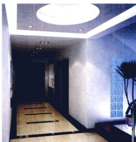
1 玄关柜为成品家具，施工做法为：现场组装，市场价格约在2800元/个。右墙面为装饰壁纸，施工做法为：用壁纸胶把装饰壁纸粘贴在墙面上，施工时注意壁纸要刮平，不留气泡或褶皱。整体造价大约在150元/平方米。
