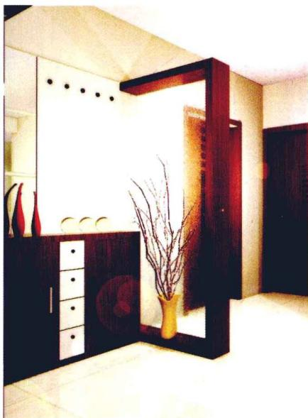
**1** 玄关隔断为饰面板材质。施工做法为：先按照设计图纸用木龙骨做出框架及结构，之后骨架要做防虫、防火处理。然后按设计图纸裁切大芯板，要求尺寸精确。用裁切好的大芯板作为底材，同时装饰玻璃要安装完毕，表面封饰面板，用汽钉固定，最后饰面板表面刷哑光清漆、挂衣背板喷白色木器漆。整体造价大约在3500元/项。
