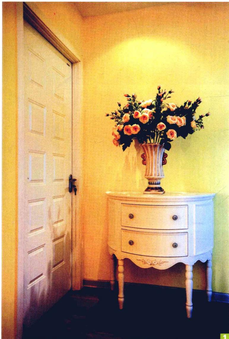
**1** 玄关柜为成品家具，施工做法为：现场组装。市场价格约在1800元/个。墙面为乳胶漆材质，施工做法为：先将墙面上的起皮杂物等清理干净，之后用配好的石膏腻子将墙面等破损处找平补好，腻子干燥后用砂纸将凸出处打磨平整。然后用橡胶刮板横向满刮腻子，接头处不得留槎，每一刮板最后收头时要干净利落。最后涂刷1~3遍乳胶漆。整体造价大约在60元/平方米。
