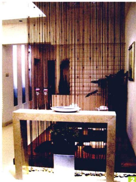
**2** 玄关隔断为人造石材质。施工做法为：先用大芯板按照设计图纸做出框架，与地面用钢钉固定。之后按设计图纸裁切人造石，然后用大理石胶粘结在一起。最后将人造石套装在大芯板框架上（可把人造石部分理解为盖子，大芯板部分理解为盒子，用盖子盖住盒子）。整体造价大约在1800元/项。
