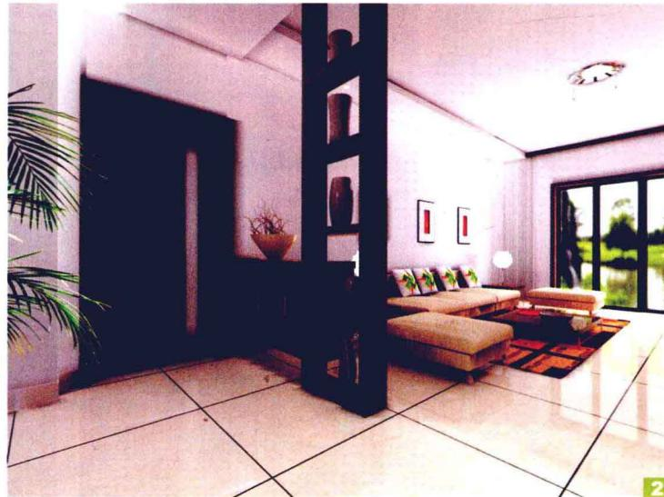
**2** 玄关隔断为饰面板材质。施工做法为：先按照设计图纸用木龙骨做出框架及结构，然后按设计图纸裁切大芯板，用裁切好的大芯板作为底材，表面封饰面板，用汽钉固定，最后饰面板表面刷哑光清漆。整体造价大约在3000元/项。
