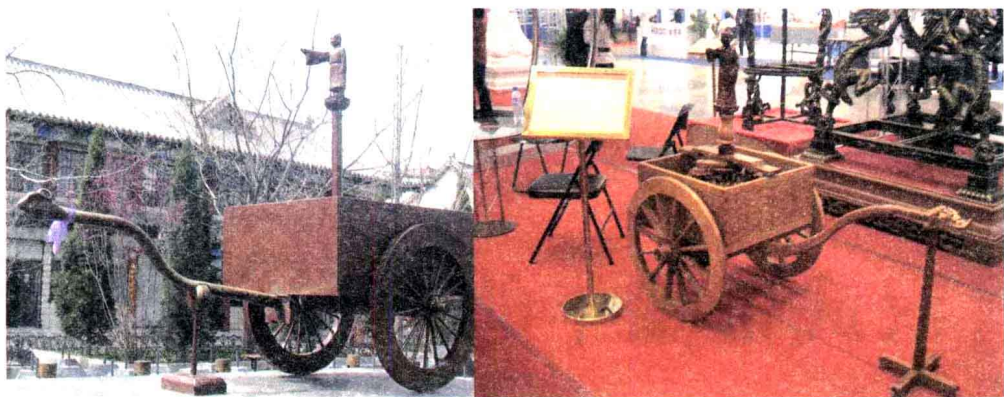
指南车，又称司南车，是中国古代用来指示方向的一种机械装置。
