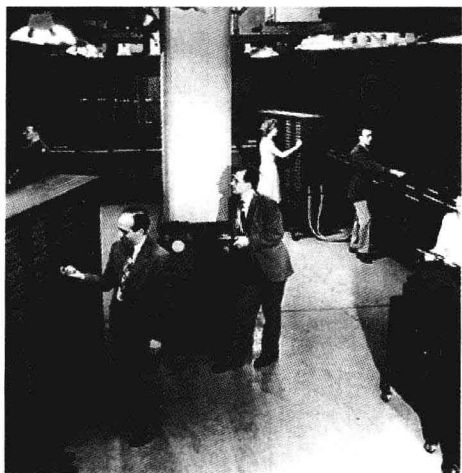
图 1-1 世界上第一台电子计算机 ENIAC
