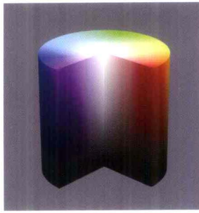
图3-20 三维的颜色柱，其中色调和饱和度的表示和前面是一样的，但加了第三轴来表示亮度信息
