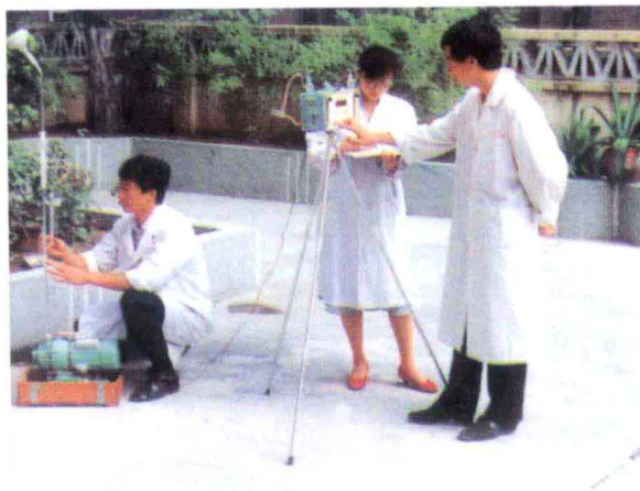
可策方圓 20 公里的全 ▼ 方位煙氣黑度自動監測儀
