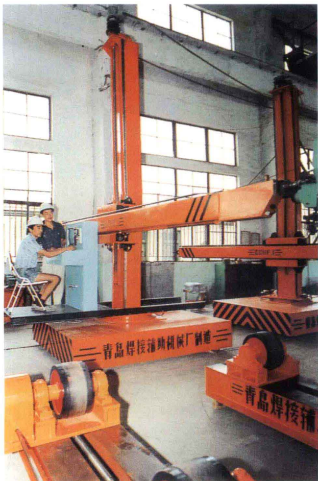
▲ 青岛焊接辅助机械厂第二代焊接操作机，具有机电一体化的特点，可对焊件进行电视监控，填补了国内空白。
