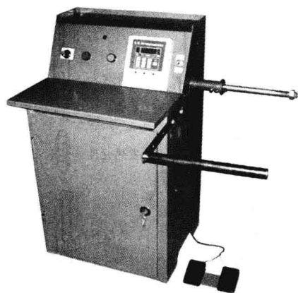
图 1-29 用专用机动绕线机绕制线圈
