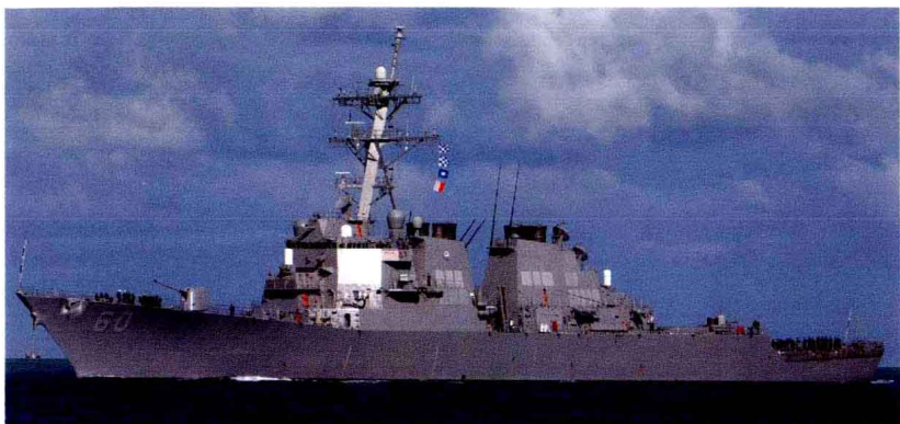
美国海军“阿利·伯克”（Arleigh Burke）级导弹驱逐舰“保罗·汉密尔顿”（Paul Hamilton）号排水量大，设计有高耸的中央上层建筑，安装了大型电子设备及天线阵列以及强大的导弹武器系统，是专门为冷战时期的作战需求而设计的
