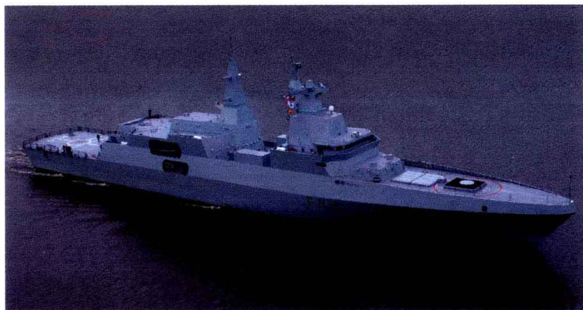
在这艘南海军护卫舰“曼迪”（Mendi）号上可以清楚地看到它的隐身设计特征。不仅两舷侧都采用了倾斜设计，而且所有甲板上层的建筑物和设备表面都尽可能地进行了隐藏处理
