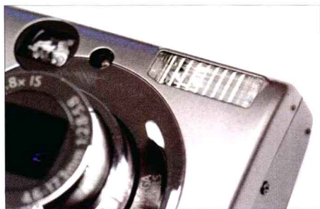
▲没有热靴设计的数码相机就只能使用内置闪光灯了。
