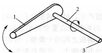
图 1.7 扭杆弹簧示意图
