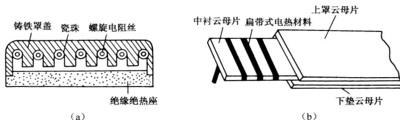
图 1-1 罩盖式电热元件
