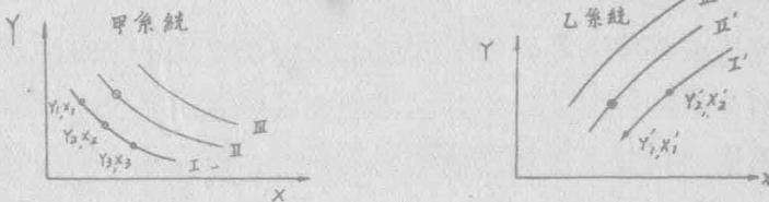
如果實驗從另一不同熱平衡開始，我們可得甲系統的等溫線 II 與乙系統 II' 上各狀態互為熱平衡，同理可得 III III' \dots 等。應用第零定律可得到丙、丁等系統的相當的等溫線。由以上的討論可知每條等溫線所代表的溫度是變數  $Y, X$  的函數。我們從以上的討論可以看出溫度的概念和我們日常生活上所理解的溫度為物體的熱冷的程度的概念完全相同。我們日常經驗知道當兩物體放在一起經過很長時間後，它們熱的程度必定達到相同程度，但是為了熱力學和統計力學的研究我們需要有這學理上的了解。
