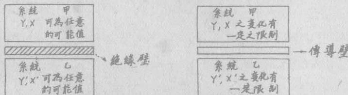
若系統甲乙經達到平衡態則 $Y, X$ 之值將保持一定，若系統乙也達到平衡態則 $Y', X'$ 之值將保持一定。如將甲乙兩系統放於一起，中間隔一絕緣壁（如厚木板，石棉等），則甲乙的狀態都沒變化，互不影響。如系統甲換另一平衡態，或系統乙換另一平衡態，彼此毫無關係，但是如果甲乙兩系統中間是一傳導壁（如薄金屬板），雖然兩系統已經各自達到平衡，放在一起後， $Y, X$ 和 $Y', X'$ 的值將自動變化，直至兩系統達到共同平衡狀態止。即以上所說的熱平衡，這就是說熱平衡時 $Y, X$ 和 $Y', X'$ 之間存在一個一定的關係， $Y, X, Y', X'$ 的值不是任意的，
