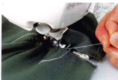
16 拉线, 拆掉粗针脚缝线。
