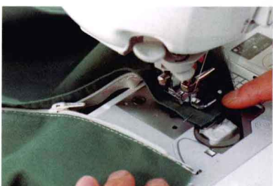
18 放下压脚, 车缝剩余部分。
