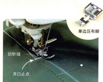
14 把车缝压脚换成单边压脚。从开口止点侧回针缝2次, 然后车缝在线上。
