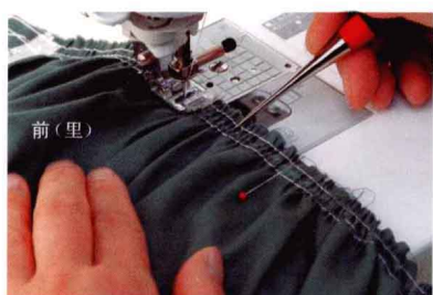
8 使用锥子均匀整理碎褶。然后用左手压住碎褶车缝。
