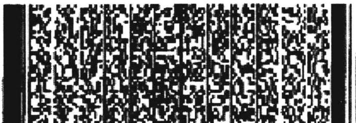
PDF417 是一个多行、连续性、可变长、包含大量数据的符号标识。每个条码有 3-90 行，每一行有一个起始部分、数据部分、终止部分。它的字符集包括所有 128 个字符，可表示数字、字母或二进制数据，也可表示汉字。一个 PDF417 条码最多可容纳 1850 个字符或 1108 个字节的二进制数据，如果只表示数字则可容纳 2710 个数字，所以它不需要连接一个数据库，本身可存储大量数据。PDF417 的纠错能力分为 9 级，级别越高，纠正能力越强。由于这种纠错功能，使得污损的 417 条码也可以正确读出。
