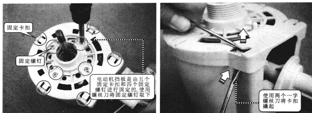
a) 使用螺丝刀将电动机挡板上的固定螺钉取下, 并使用一字螺丝刀将卡扣撬起
