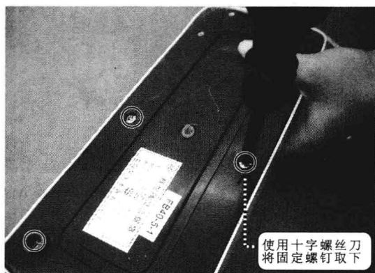
b) 将挂片取下，在使用螺丝刀将卡片上的固定螺钉取下
