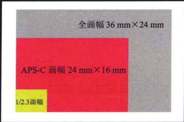
数码单反相机感光元件和便携式数码相机CCD大小的比较
