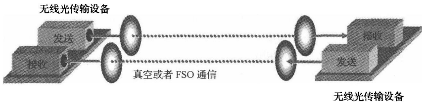
图 1-1 无线激光通信系统示意图
