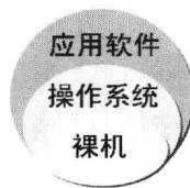
显然，裸机是操作系统的安装和运行平台，而操作系统则是应用软件的安装和运行平台。其中，应用程序处于最上端，它离开
