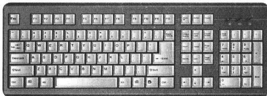
这些按键既可以单独使用，也可以组合使用，如，开机时按下 Del 键可以进入主板的 BIOS 设置界面、同时按下“Ctrl+Alt+Delete”键可以让电脑执行重新启动的操作，等等。
