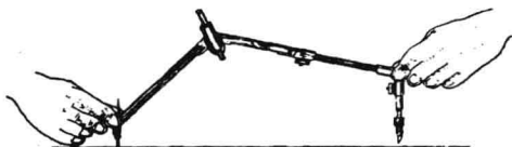
图1-6 加入延伸插杆用双手画较大半径圆
